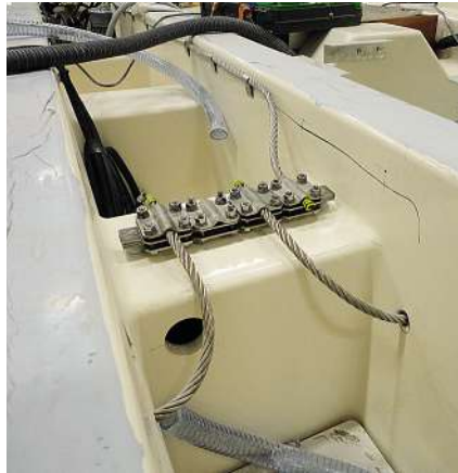
Bild 7: Lage der Anschlussfahnen und Ableitungen im Schiffsrumpf
