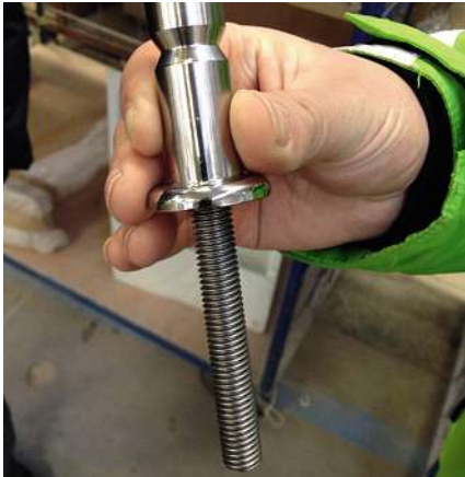
Bild 5: Relingstütze, im Randbereich der Rumpfschale verschraubt
