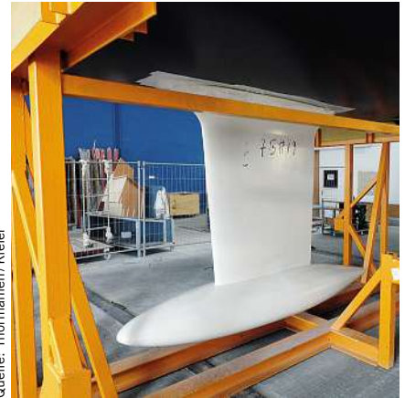
Bild 9: Als Erdungssystem dient hier der Stahlkiel (Gusseisen)
